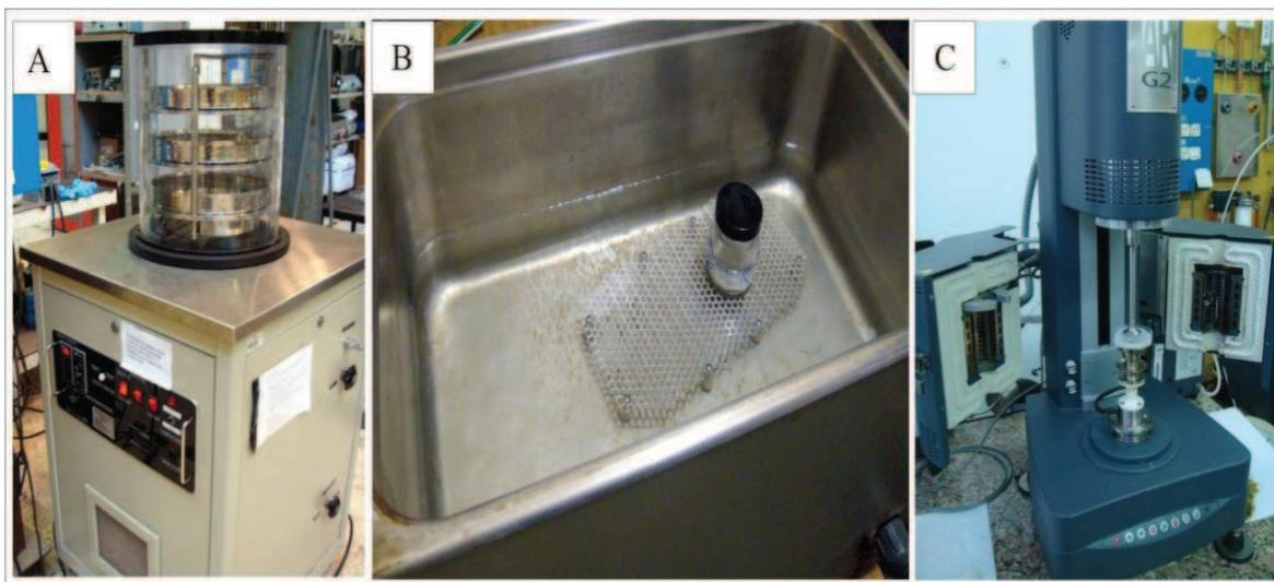
Figura 11.1: A. Liofilizador. B. Ultrasonido. C. Reómetro.
