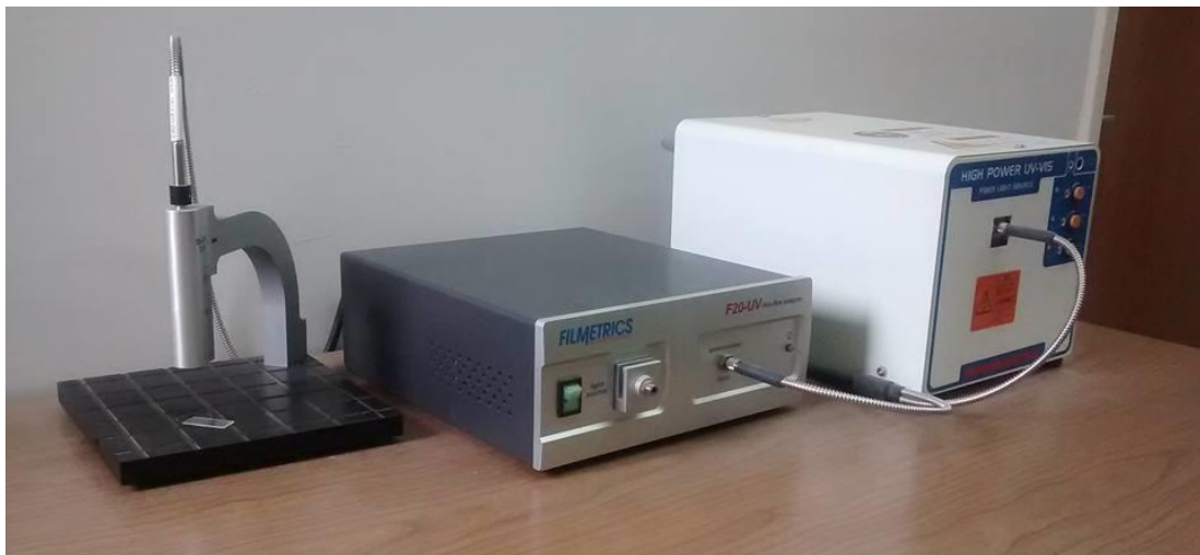
Figura 5.3. Espectrómetro de reflectancia F20-UV con la lámpara de deuterio y la sonda FO-SPLT-UV
