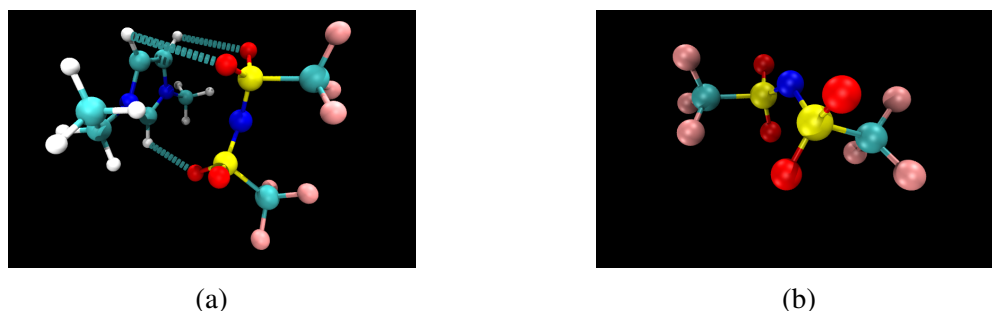
Fig. 5.2 Representaciones atomísticas de (a) [emim][Tf 2 N] [257] y (b) del anión [Tf 2 N] - , obtenidas en simulaciones de DM de los sistemas aislados (Ver versión electrónica en el repositorio http://repositoriodigital.uns.edu.ar para figuras a color).
