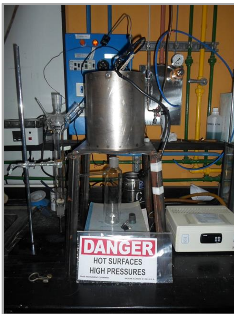
Figura 3.2 Reactor de pirólisis
