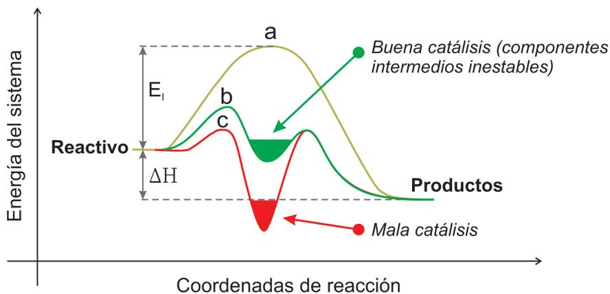
Figura 1.4: Interpretación del Principio de Sabatier en los gráficos de energía potencial. La línea a corresponde a la reacción sin catalizar, mientras que las líneas b y c representan la reacción catalizada con un compuesto intermediario inestable o demasiado estable respectivamente.
