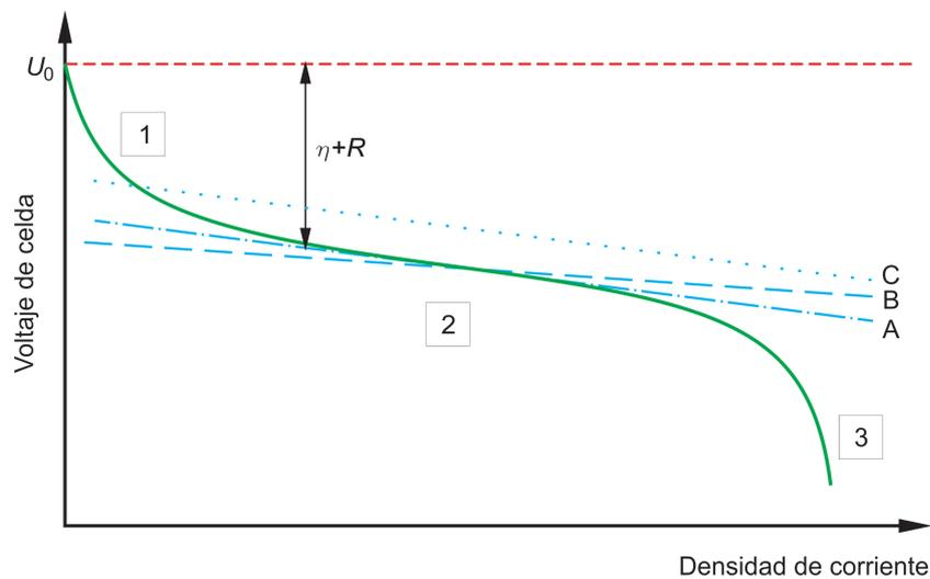
Figura 1.9: Curva característica I-V de una celda de combustible DMFC.
