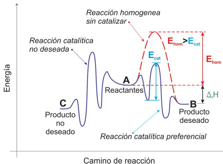
Figura 1.3: Energías de activación y sus relaciones con un catalizador activo y selectivo. Donde  $E_{hom}$  es la barrera de activación para la reacción homogénea;  $E_{cat}$  es la barrera de activación cuando se usa un catalizador;  $\Delta_r H$  es el cambio en la entalpía de los reactivos comparados con los productos.
