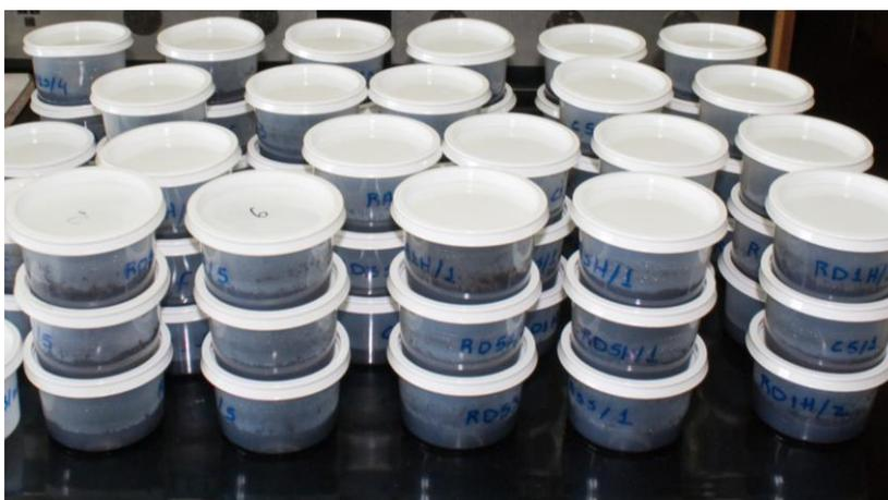
Figura 5.3: Ensayo de mineralización potencial en condiciones controladas de temperatura y humedad. La incubación en laboratorio se realiza durante 30 días, una vez a la semana se corrige el contenido de humedad dejando las muestras expuestas al aire durante 1 hora.
