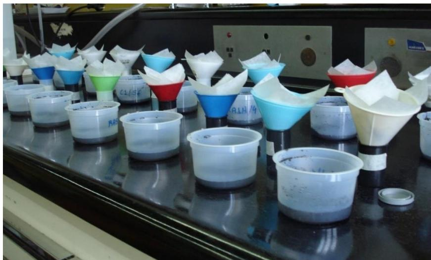
Figura 5.1: Extracción de muestras de suelo con KCl 2N.
