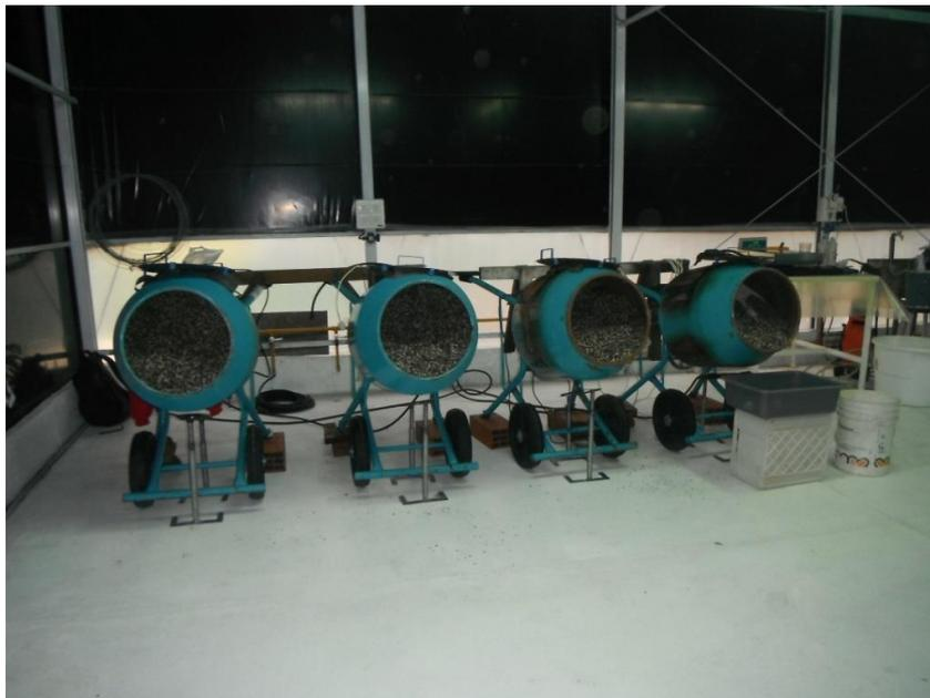
Figura 11: Equipo para descontaminación de sustrato.
