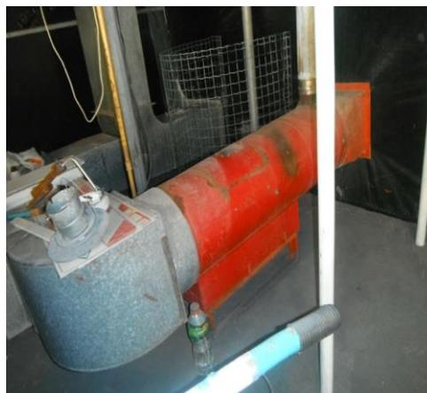
Figura 10: Sistema de suministro de aire caliente mediante cañón calefactor.
