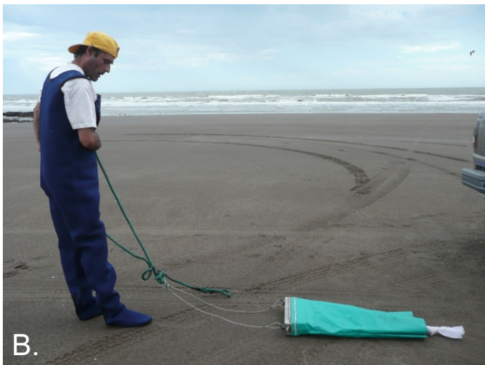
Lámina III. Muestreo biológico en la zona del surf . A. y B. muestreador: rastra biológica, C. toma de la muestra.
