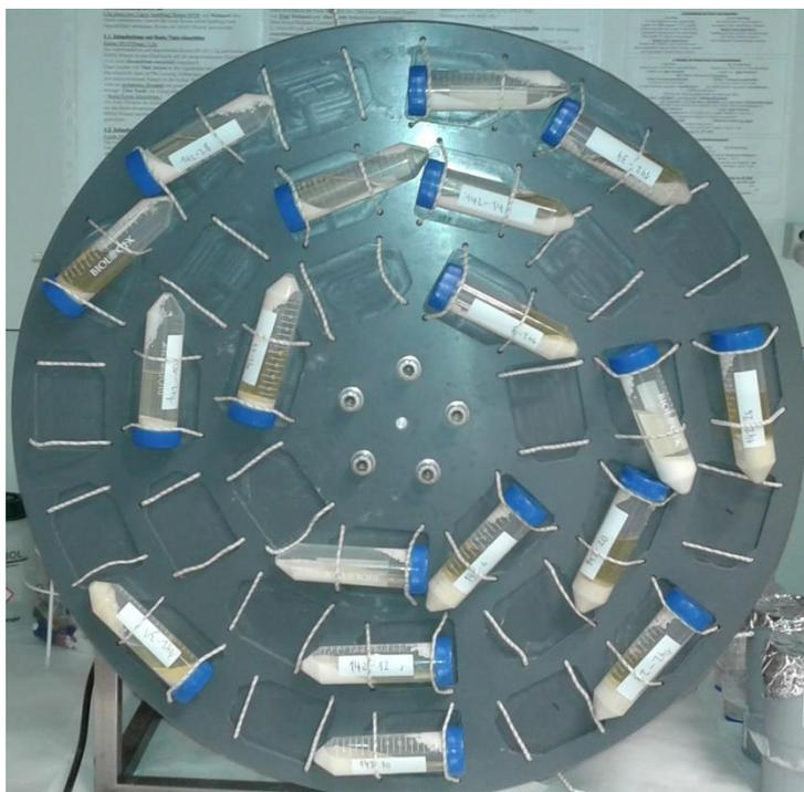
**Figura 3.2:** Rueda giratoria empleada para la extracción del AD adsorbido por la resina HP20 de los SPATTs colocados en los golfos Nuevos y San José.
