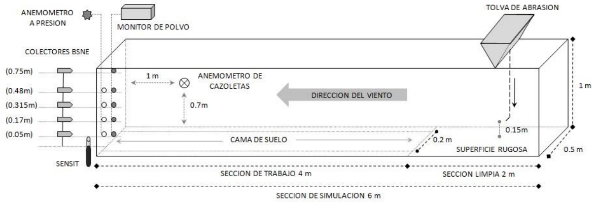
Figura 18. Esquema de la sección de trabajo del túnel de viento.
