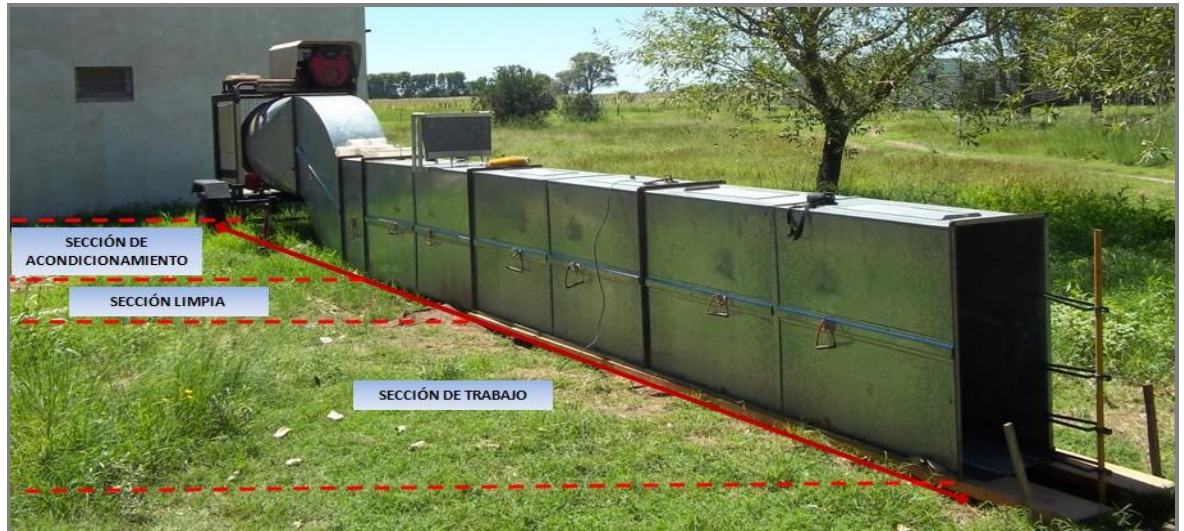
Figura 13. Vista de las distintas secciones del túnel de viento.
