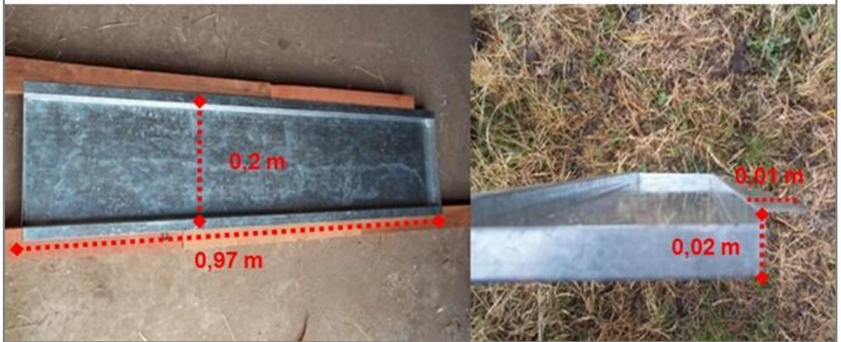
Figura 14. Detalle (vista transversal) de la bandeja y listones de madera que se colocan sobre el piso del túnel.
