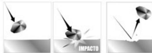
**Figura 2.14 - Esquema de desgaste erosivo [Fitch y Troyer, 2004]**
