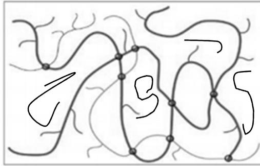
**Figura 1.10 - Esquema de red molecular con algunas moléculas todavía formando parte del material soluble**
