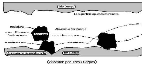
**Figura 2.13 - Esquema de abrasión por tres cuerpos [Stachowiak y Batchelor, 2014]**
