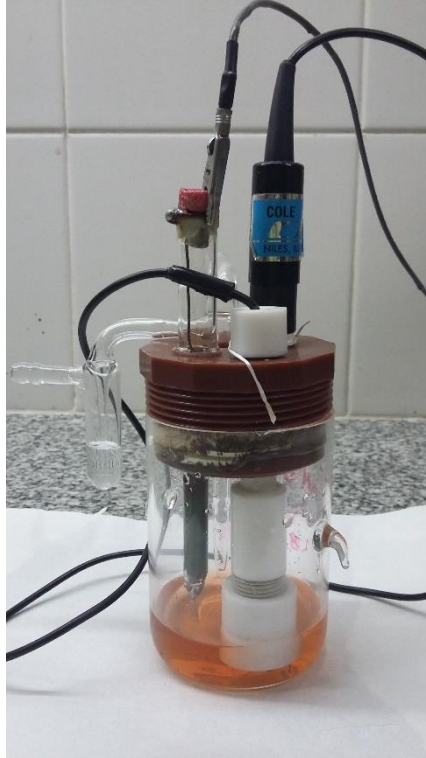
Figura 2.1. Celda electroquímica empleada.
