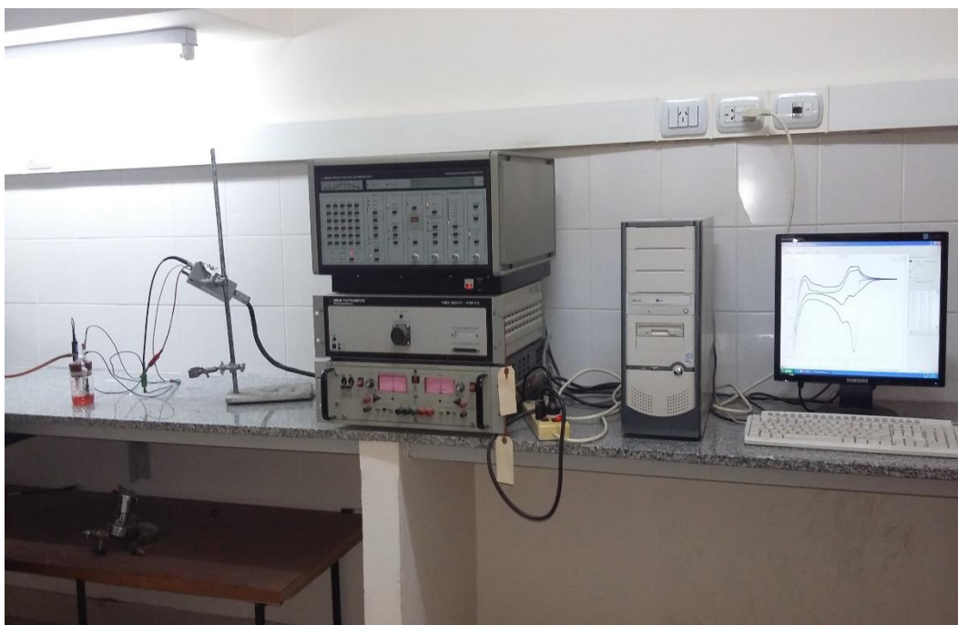
Figura 2.2. Equipamiento empleado para las mediciones electroquímicas.
