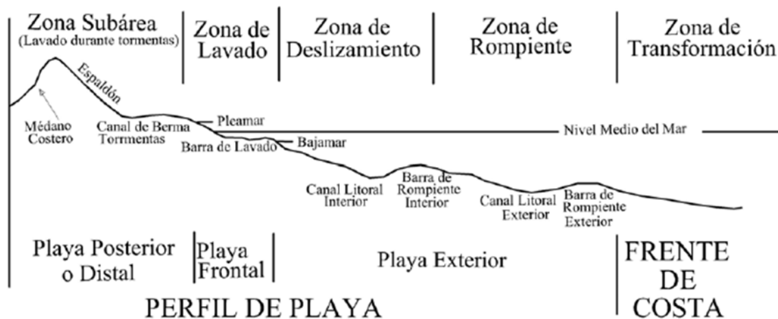
Figura 1 B. Perfil transversal de una playa típica donde se indican las zonas hidráulicas y denominación de los elementos morfológicos básicos (Perillo, 2003).
