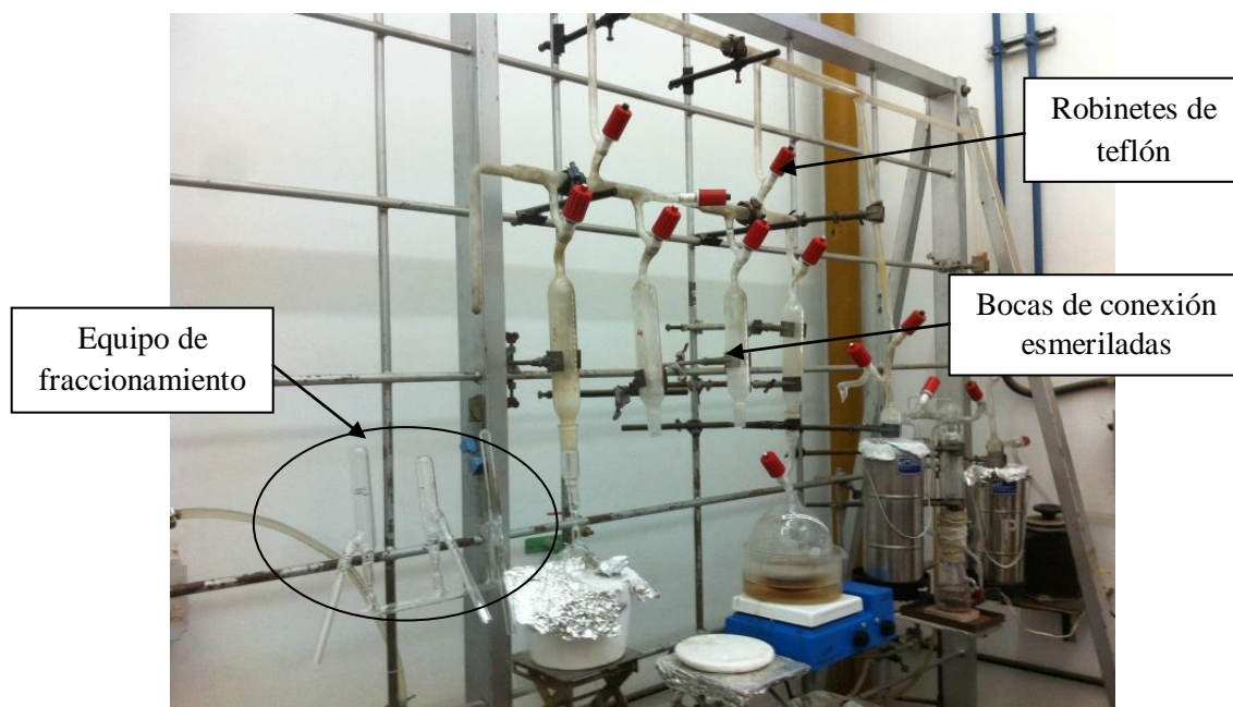
Figura 4.1. Línea de vacío a la cual se encuentra conectado el equipo de fraccionamiento de la solución de NIPAAm.
