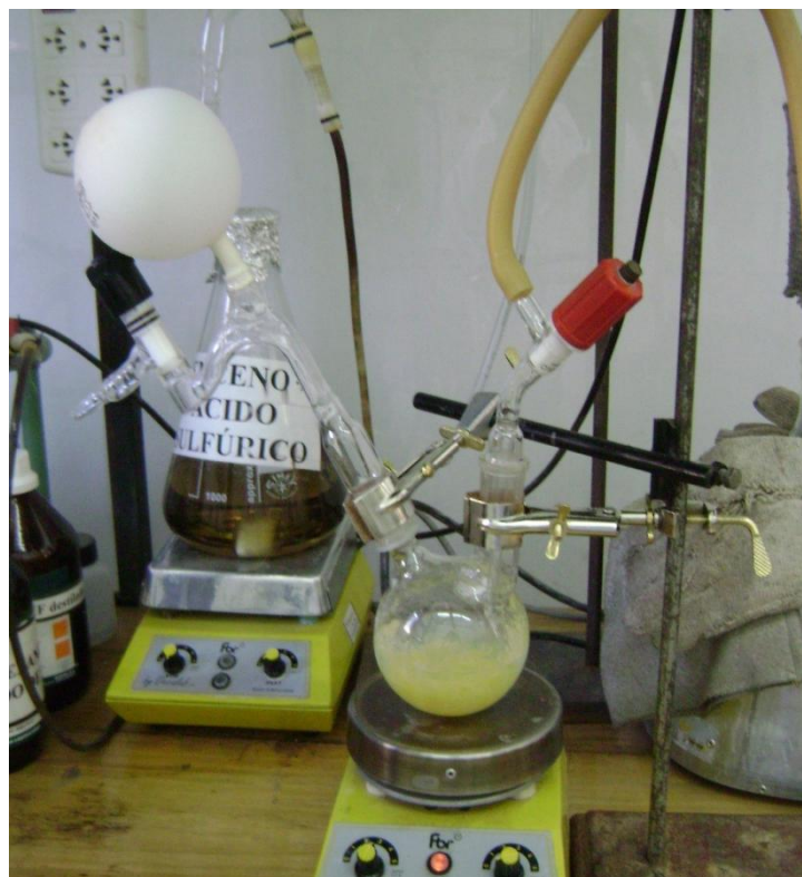
Figura 3.1. Reactor de vidrio de dos bocas donde se llevaron a cabo las reacciones de síntesis de copolímeros alginato-g-PNIPAAm empleando CAN/HNO 3 .
