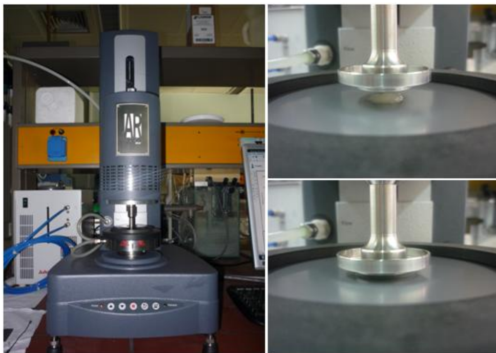
Figura 5.13. Reómetro AR2000 TA Instrument con plato Peltier termoregulado y tapa cobertora. Colocación de la muestra.
