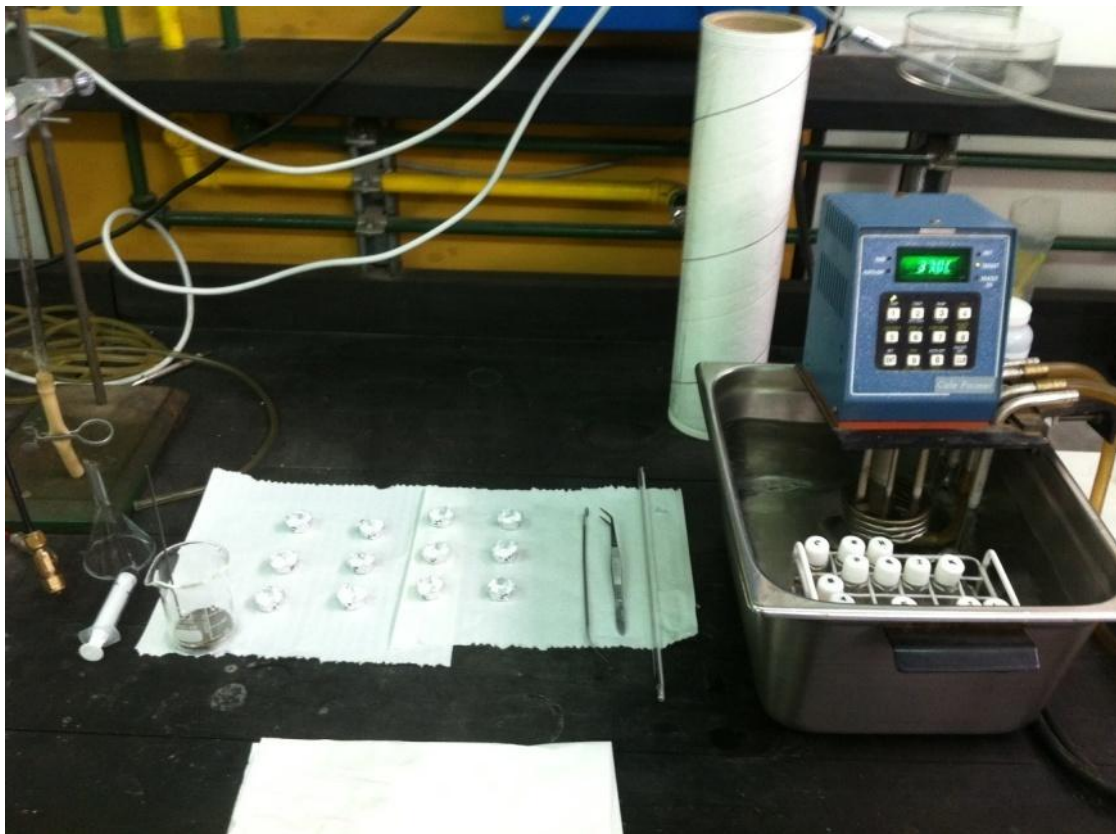
Figura 6.12. Mediciones del grado de hinchamiento de geles de copolímeros a 37 °C. Baño termostatzado, filtro y cápsulas empleadas para el pesado de las perlas.
