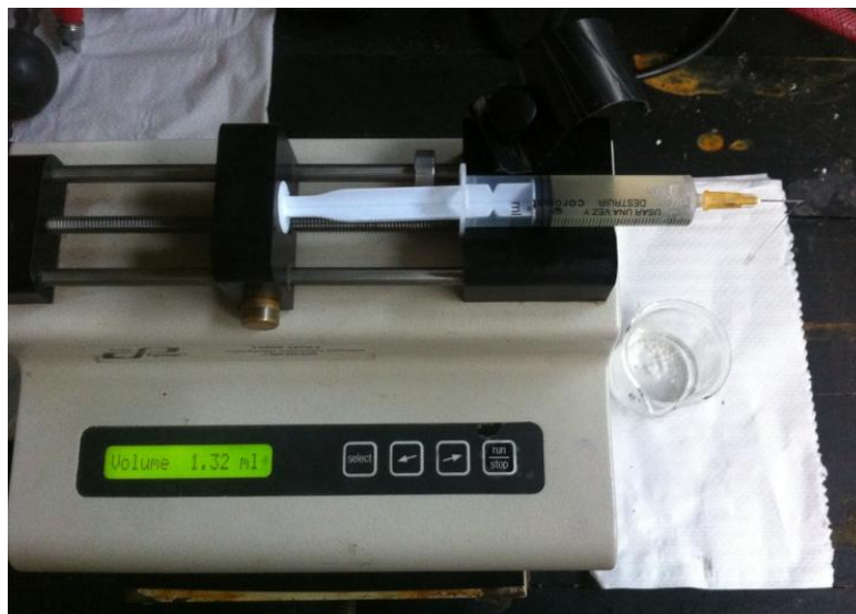
Figura 6.1. Bomba perfusora Cole Parmer 74900 Series empleada en la preparación de perlas de alginato de calcio.
