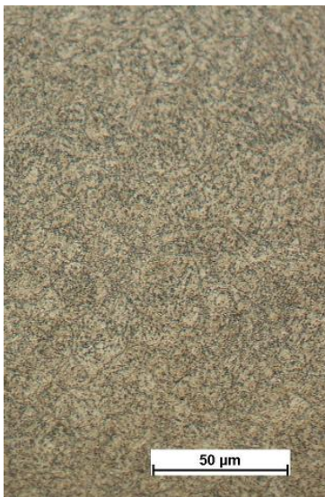
T 985 °C Aire Rev 205 °C Kalling 500 X
