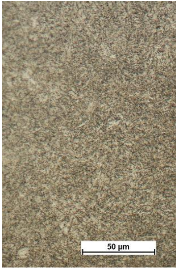
T 985 °C Aire Rev 670 °C Kalling 500 X
