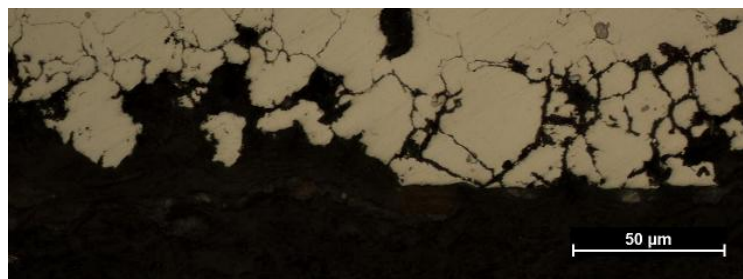
Figura 4.34: Comparación de las superficies de corrosión de las estructuras templadas y revenidas a 450 °C (500 X).
