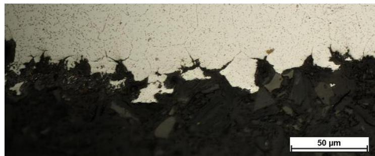
Estructuras Templadas y revenidas a 450 °C
