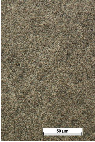
T 985 °C Aire Rev 450 °C Kalling 500 X
