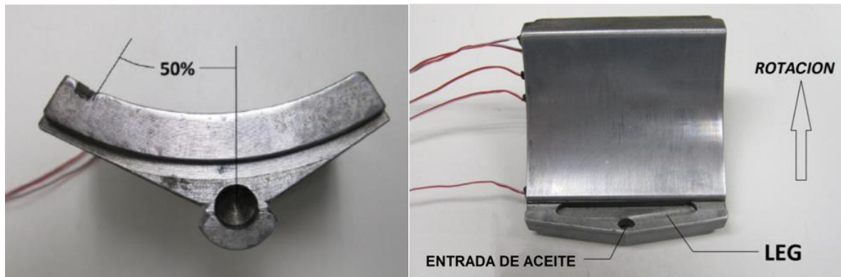
Figura 6.6: Vistas lateral y frontal de una de las zapatas del cojinete ensayado.
