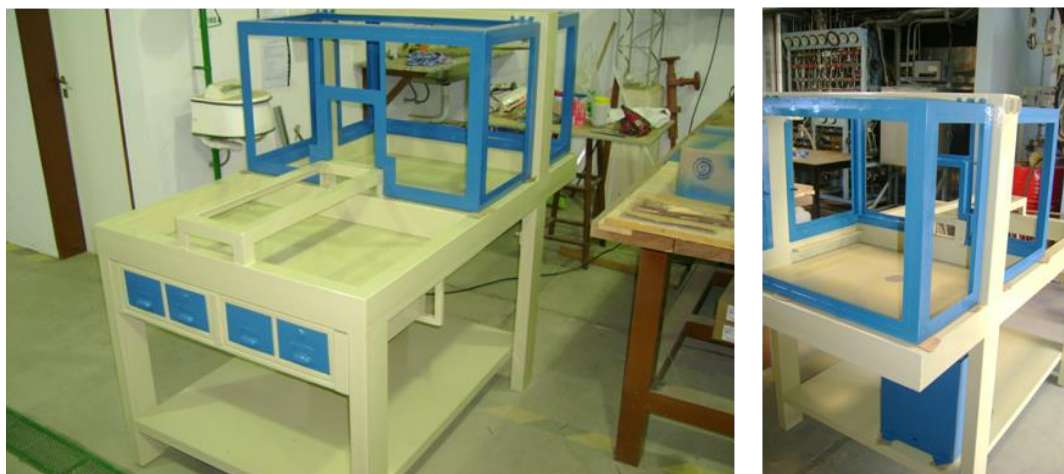
Figura 6.60: Estructura del banco pintada y lista para el montaje de los elementos mecanizados.
