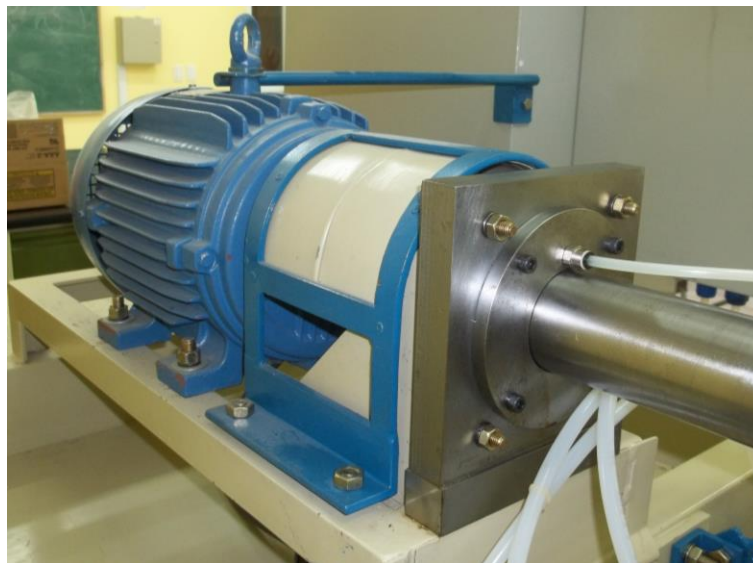
Figura 6.36: Lado motriz del eje: motor, acoplamiento (bajo el cobertor) y porta-rodamiento.
