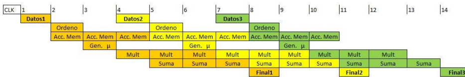
Figura 6.6: Esquemático del pipeline para un PWL de 4 dimensiones. A diferencia del pipeline anterior, se observa que se extiende la tasa de salida del PWL ya que son 5 las direcciones de memoria que se tiene leer. Al ser una memoria de doble puerto, se tiene que hacer una tercer acceso de lectura.
