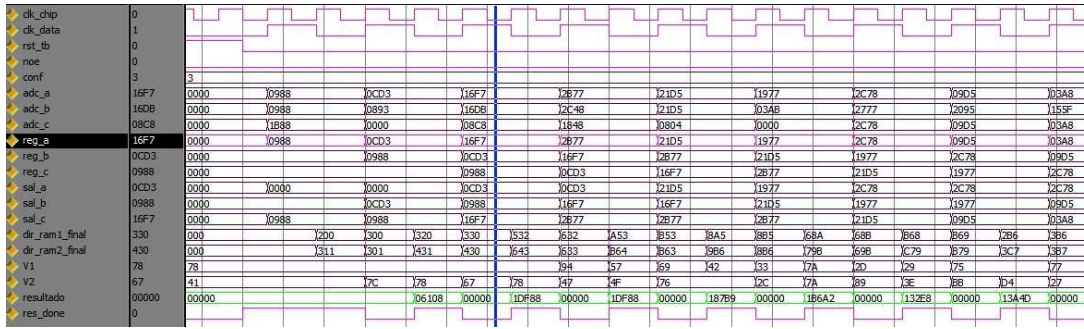
Figura 6.11: Salida para el modo número 3 de operación. La entrada del PWL es la entrada 1 y dos muestras retrasadas de la entrada. El resultado se obtiene 6 ciclos de reloj después.
