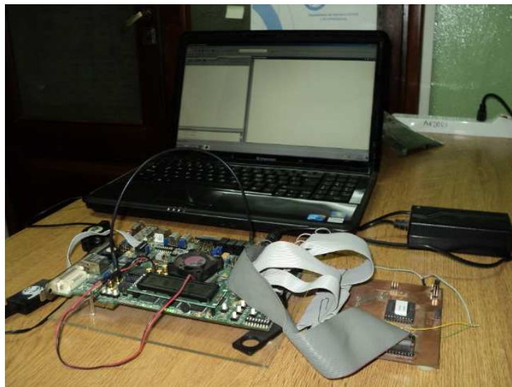
Figura 3.7: Foto del ensayo práctico del ASIC y de la FPGA. Se usa la computadora para activar la FPGA y recibir los datos finales.
