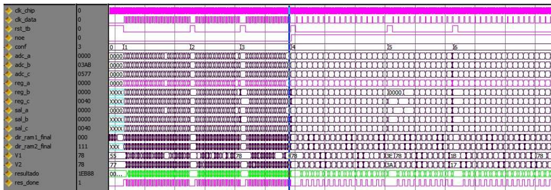
Figura 6.10: Simulación donde se puede ver los 6 modos de funcionamiento que tiene que soportar el diseño del nuevo chip. El chip se encuentra en estado de reset para el cambio de configuración. En los modos que hay realimentación de la salida, la tasa de datos baja notablemente por el retardo propio del chip.
