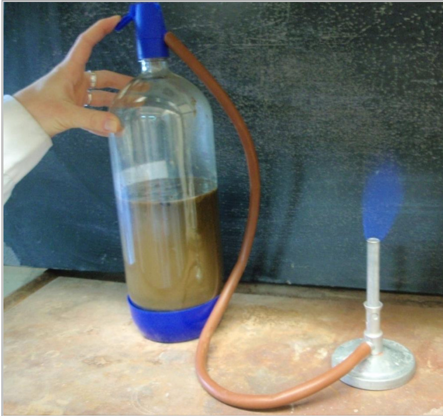
Figura 5.3 Sifón conectado a mechero de Bunsen para comprobar la producción de gas inflamable
