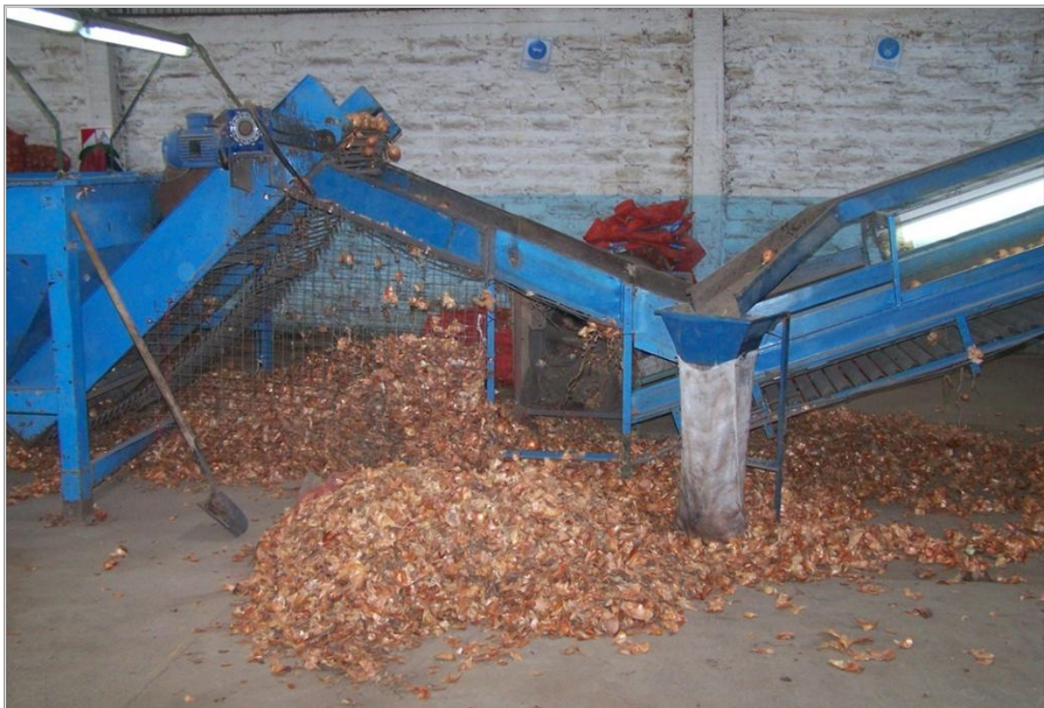
Figura 1.3 Acumulación de catáfilas durante el proceso de cepillado en el galpón de empaque
