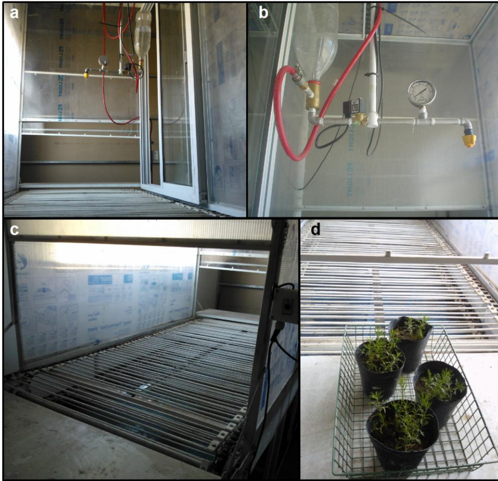
Figura 6.3. a- Vista general del equipo. b- Dispositivo pulverizador. c- Cinta transportadora. d- Plantas de B. ulicina en EVT próximas a aplicarse.
