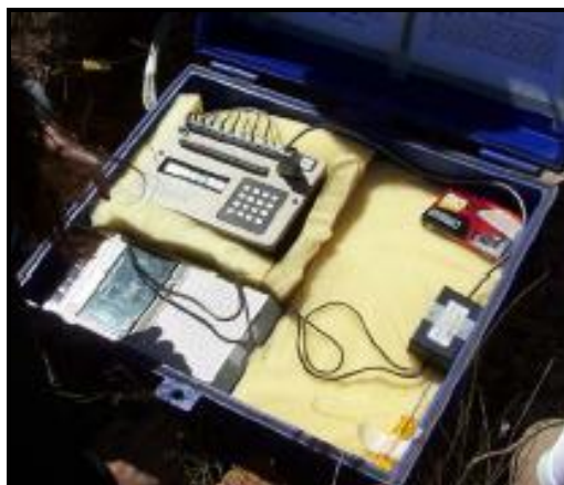
Figura 6.1. Data logger que permitió el registro de las temperaturas tomadas por las termocuplas durante la quema. Fuente: Ithurrt, 2015.
