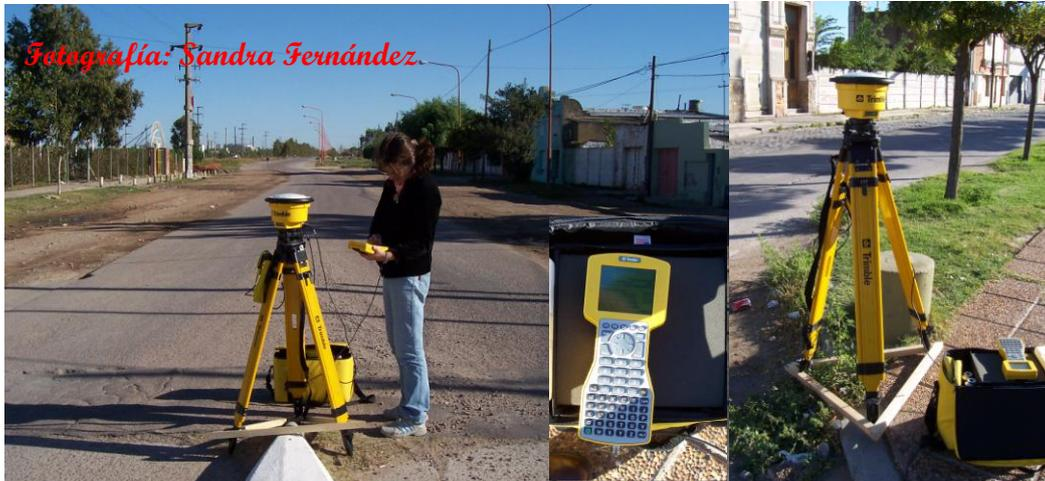
**Fotografía 2.1. Instrumental GPS utilizado en la campaña, con detalle de la controladora.**
