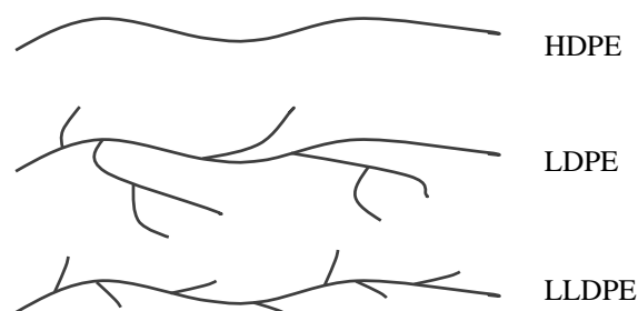
Figura 2.2. Estructura de cadena de diferentes polietilenos.
