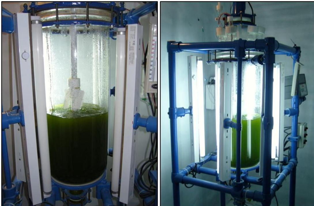
**Figura 6.1:** Cultivo de *Nannochloropsis oceanica* CCALA 978 en un fotobiorreactor columnar de 25L de capacidad.
