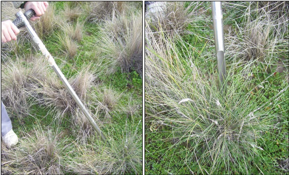
Figura 7.1. Fotografías del cilindro hoyador empleado para tomar las muestras de suelo + raíces.
