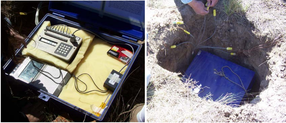
Figura 3.4. Fotografías del datalogger conectado a las termocuplas tipo K, empleados para el registro de las temperaturas de la quema.
