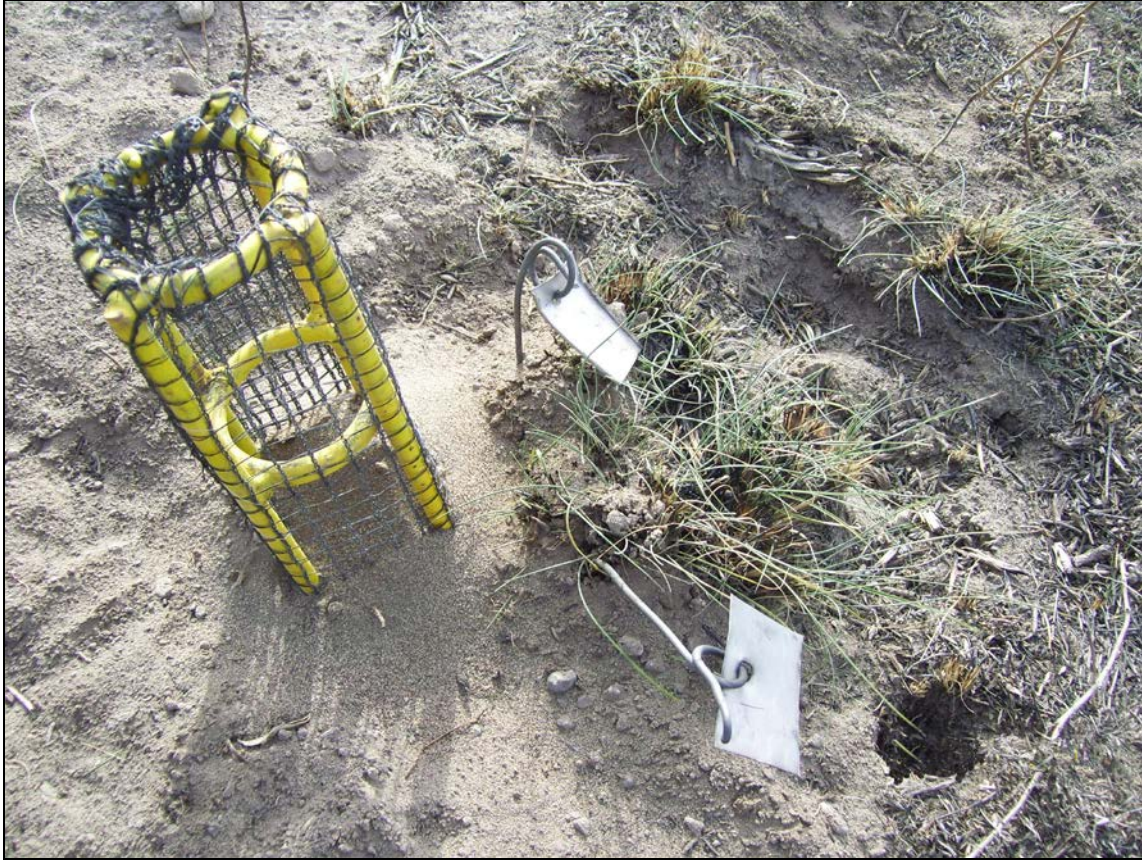
Figura 8.2. Vista de la estructura cilíndrica empleada en las mediciones de proliferación radical.
