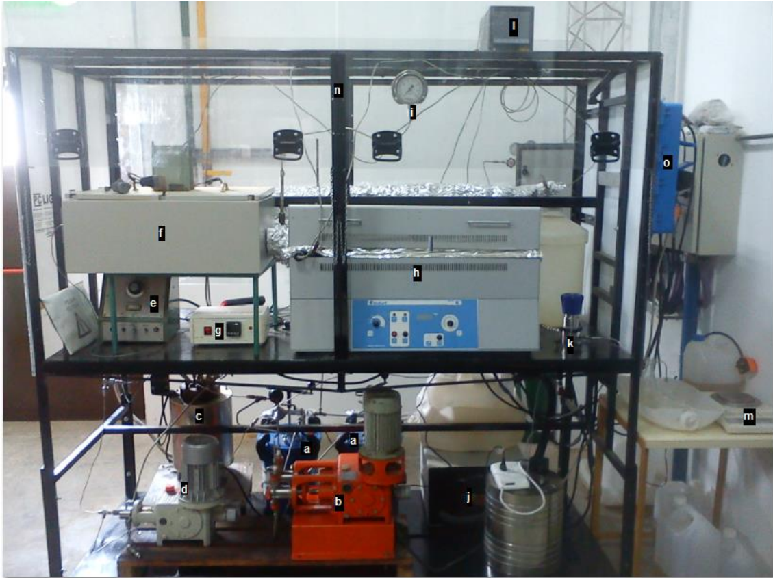
Figura 2.2: Equipo experimental para la transesterificación continua de aceites vegetales con alcoholes supercríticos.
