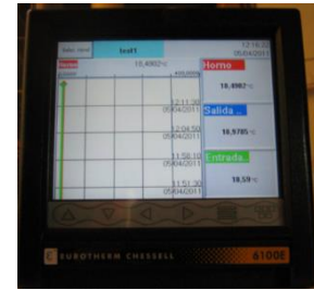
Figura 2.7: a) Controlador de temperatura Novus N480D; b) Registrador gráfico de temperaturas Eurotherm Chessel 6100E.
