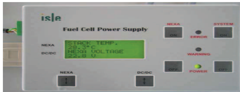
Figura 5.10. Unidad de control.
