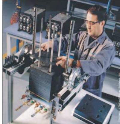
Figura 2.4. Montaje de una batería de celdas.
