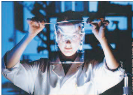
Figura 2.8. Electrolito de membrana sólida para una PEMFC.
