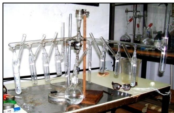
Figura 3.9. Equipo de fraccionamiento de solución de monómero D 3 en ciclohexano.
