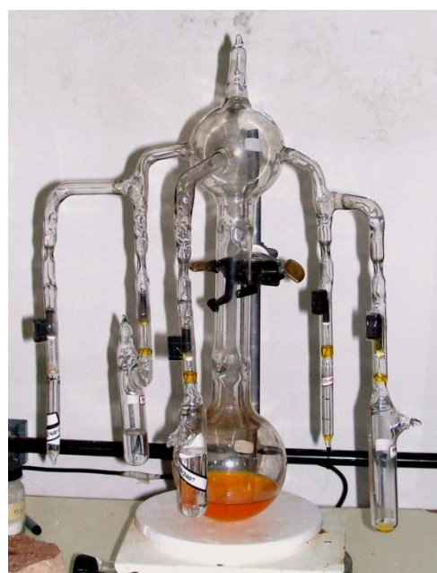
Figura 4.6 Reactor de polimerización (la solución coloreada corresponde a la formación de poli(estiril-litio), PS - Li + )
