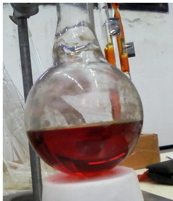
Figura 6.2 Reactor de síntesis de copolímeros bloque PS- b -PCL (luego del agregado del DFE).
