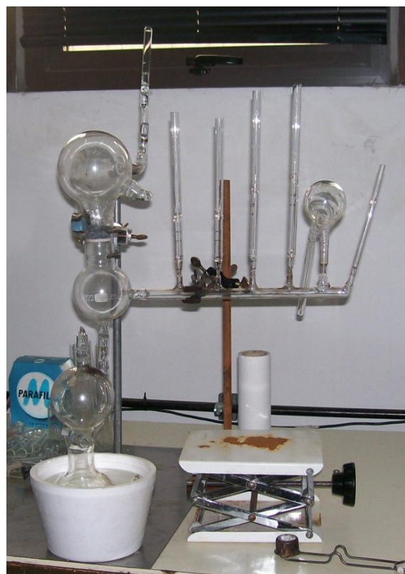
Figura 3.2. Reactor de síntesis del iniciador sec -ButilLitio.
