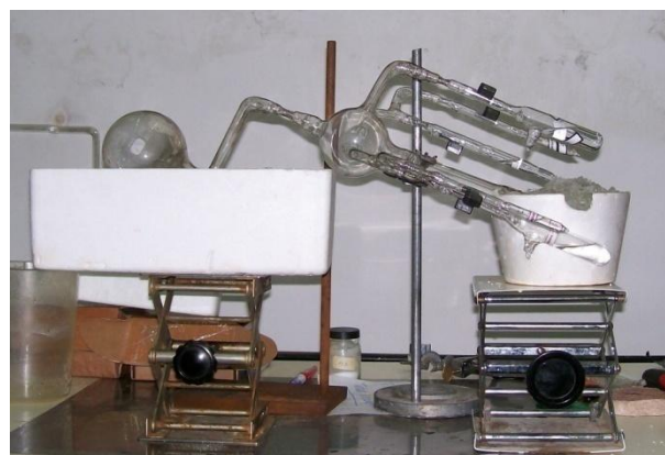
Figura 4.4. Destilación del solvente de la sección de purga al reactor.
