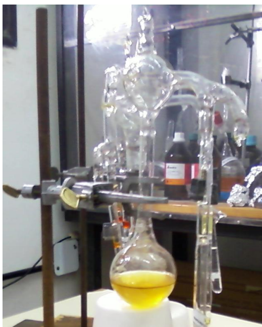
Figura 6.1 Reactor de síntesis de copolímeros bloque PS- b -PCL (solución de PS - Li + viviente).
