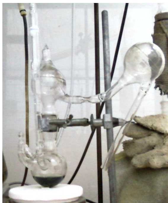
Figura 3.4. Reactor de síntesis del iniciador dilítio-naftaleno
