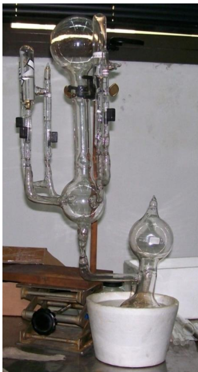
Figura 4.2 Equipo de reacción separado de la línea de vacío (el reactor es el extremo superior del equipo y la sección de purga el inferior. Esta sección se encuentra sumergida en agua para facilitar el descongelamiento del solvente contenido en su interior).
