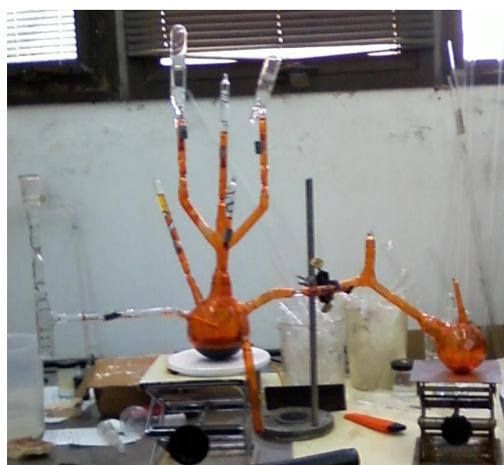
Figura 5.3 Reactor de polimerización empleado en la síntesis de copolímeros PMMA- b -PDMS.
