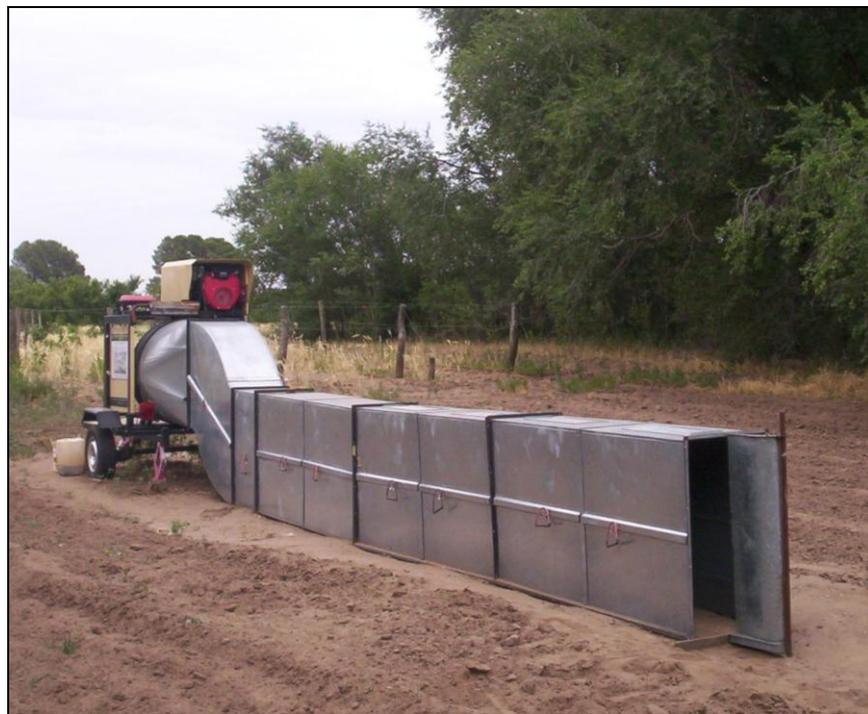
Figura 15. Vista frontal del túnel de viento portátil utilizado en este estudio.
