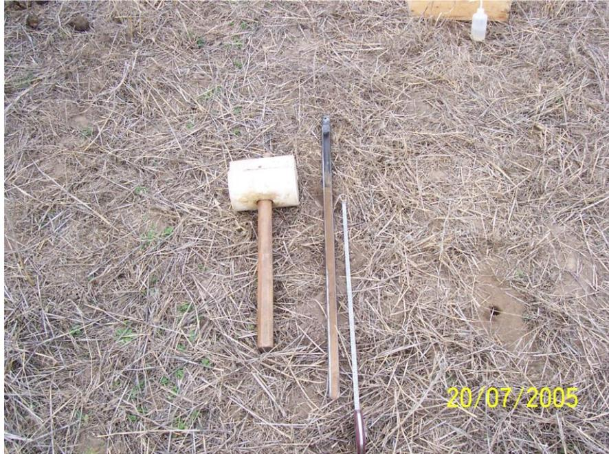
Figura 14. Elementos utilizados para la determinación de la profundidad hasta la acumulación de carbonato secundario.
