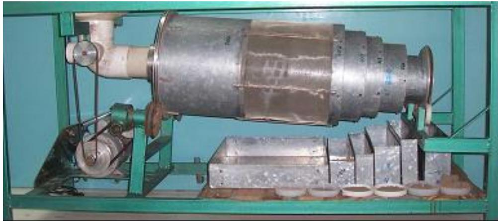
Figura 13. Vista lateral de un tamiz rotativo.
