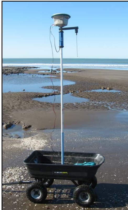
Figura 6.6. Vista del DGPS-RTK utilizado en las mediciones de perfiles de playa.
