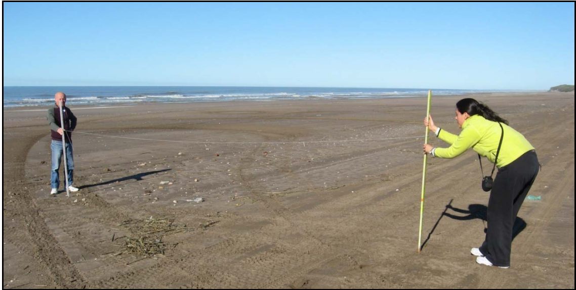
Figura 6.5. Medición del perfil de playa con el método Emery.
