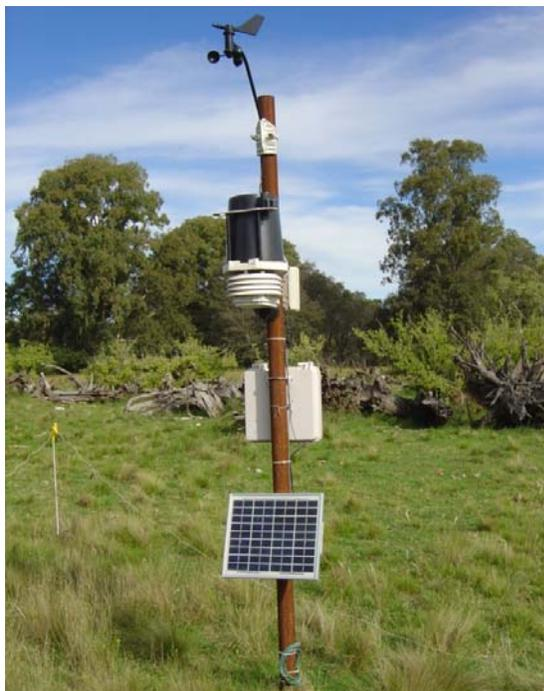
Fig. 31. Estación Meteorológica Davis Weather Monitor II instalada en la Estancia El Arbolito.
