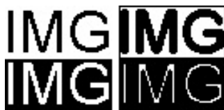
Figura 2.8: Erosión de una imagen.
