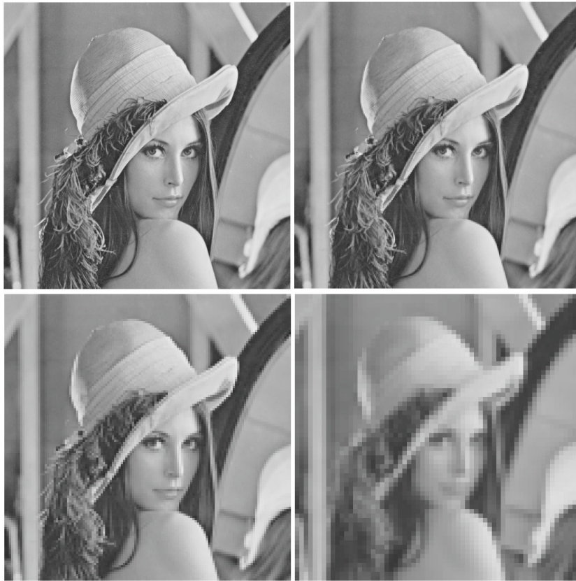
Figura 2.2: Variaciones de una imagen al variar la cantidad de pixeles( 512 \times 512 , 256 \times 256 , 128 \times 128 , 64 \times 64 ).
