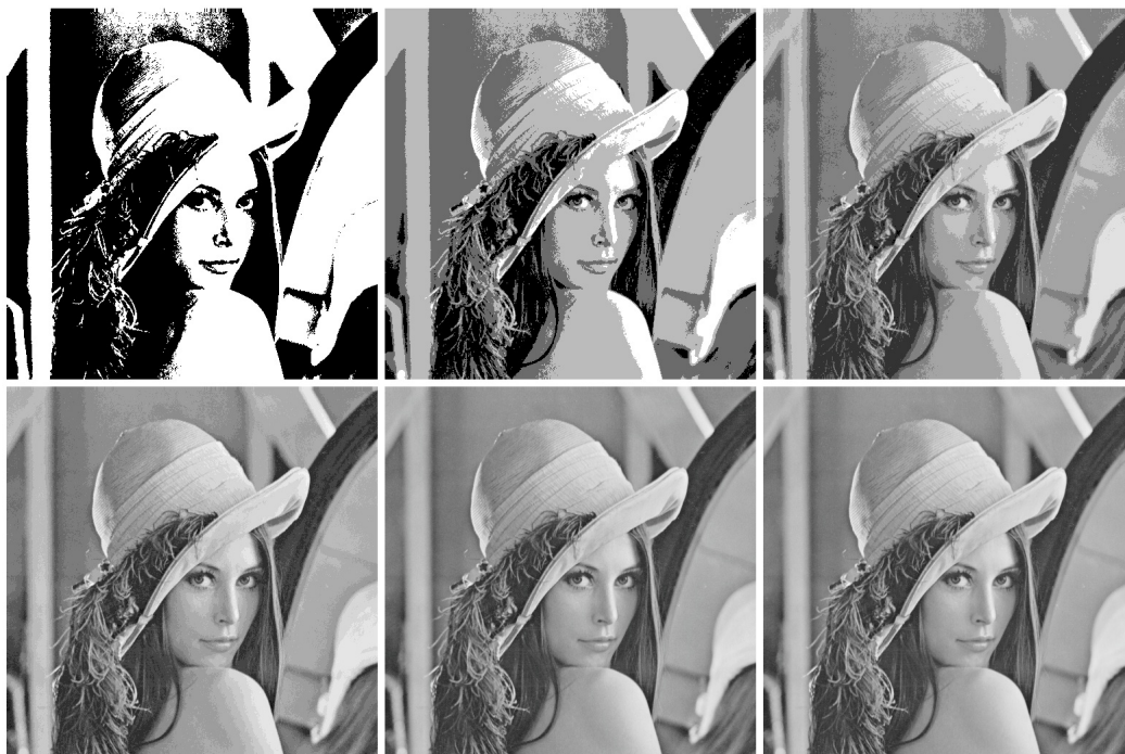
Figura 2.3: Variaciones de una imagen al variar la cantidad de bits con la que se representa (1, 2, 3, 4, 6 y 8 bits).
