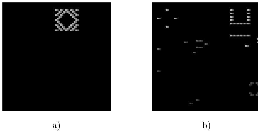
Figura 7.39: a) Búsqueda de pixeles aislados; b) Búsqueda de finales de línea.
