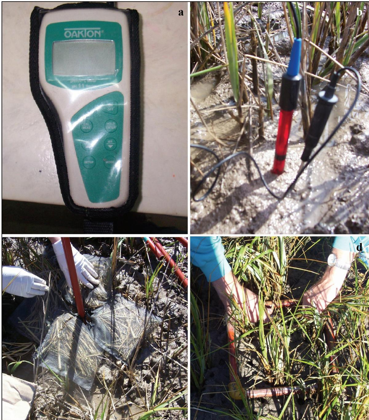
**Fig. 2.1.** Instrumental y tareas a campo: (a) sonda OAKTON para medición de pH, Eh y temperatura en sedimento, (b) Medición de Eh y temperatura con los sensores correspondientes, (c) Bolsas con material vegetal para determinación de tasa de descomposición y (d) Recolección de muestras de biomasa aérea utilizando parcela.
