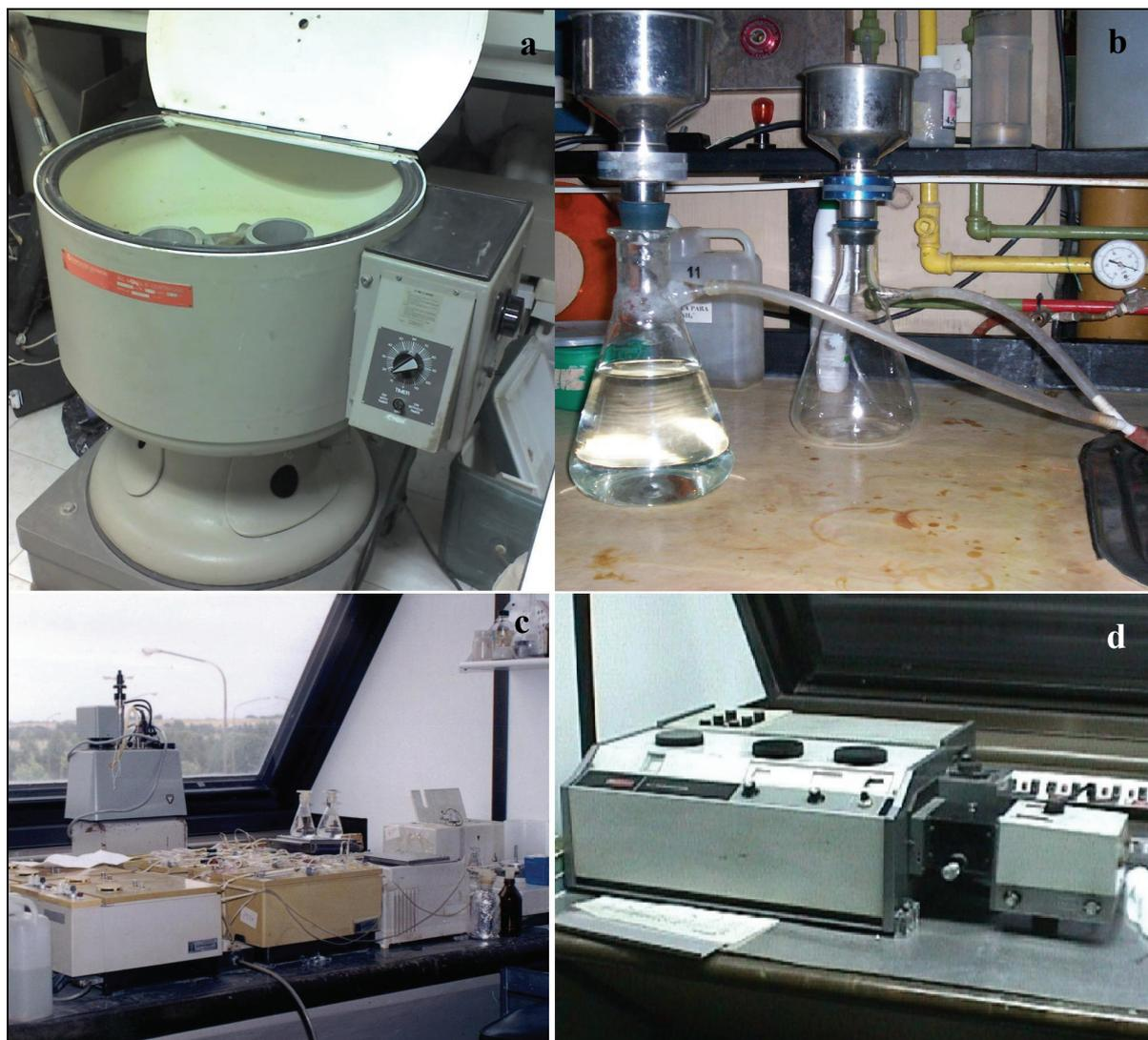
**Fig. 2.2.** Parte del instrumental utilizado en el laboratorio: (a) centrífuga usada para obtención de agua intersticial; (b) equipo de filtración; (c) autoanalizador automático AA-II; (d) espectrofotómetro Beckman DU-2.
