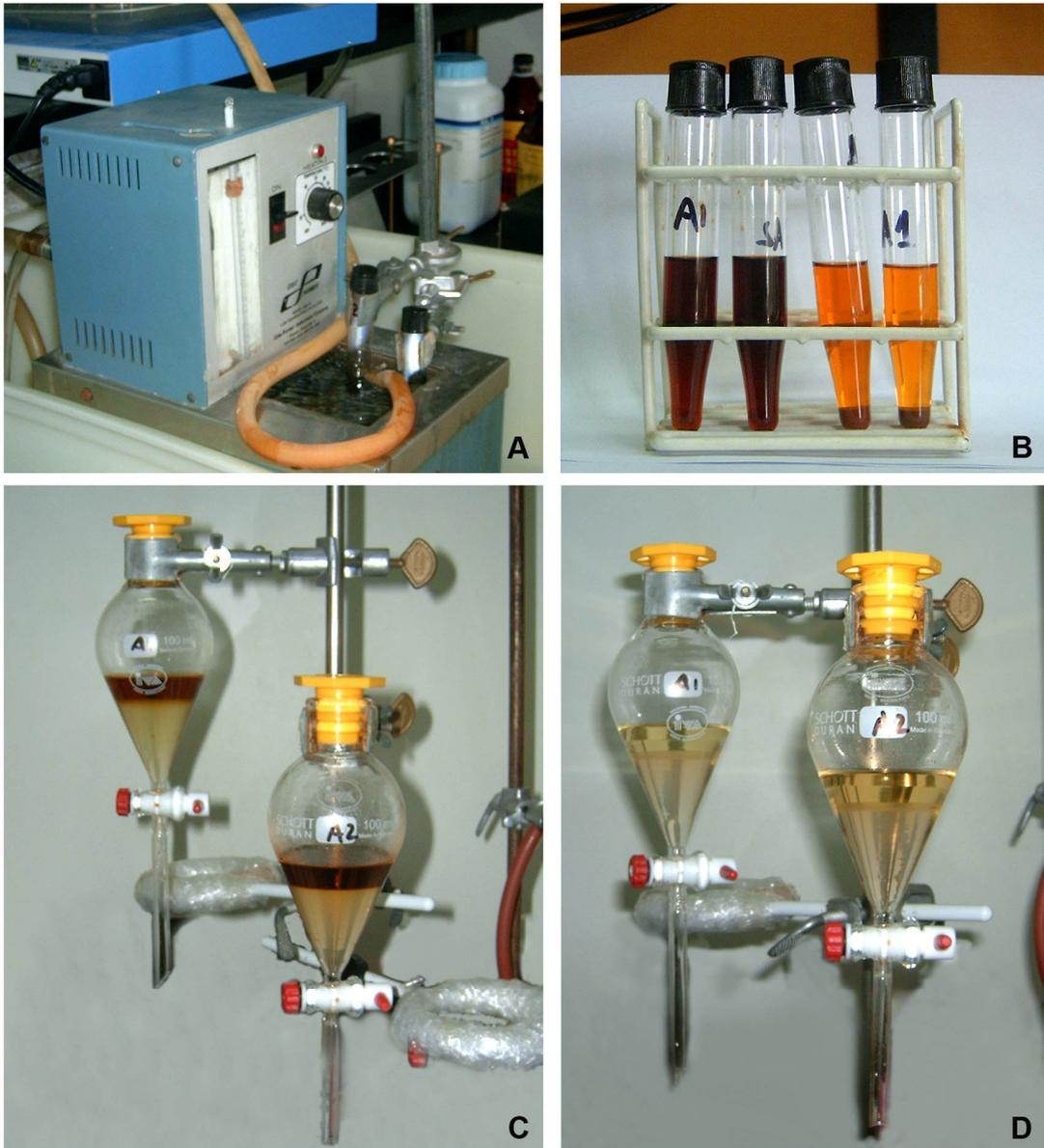
**Figura 3.** Extracción de lípidos en *Haematococcus pluvialis* con el método Zhekisheva et al. 2002. **A:** baño termostatzado con la primera extracción con metanol. **B:** primera y segunda extracción con metanol. **C:** sistema bifásico resultado de la mezcla del extracto metanólico con dietil eter, hexano y agua. **D:** sistema bifásico resultado de la mezcla de la fase inferior de la decantación anterior con dietil eter:hexano.
