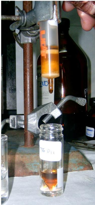
**Figura 5.** Fraccionamiento lipídico en *Haematococcus pluvialis*. Elusión de lípidos neutros con distintos solventes; notar la coloración rojiza del pigmento astaxantina.
