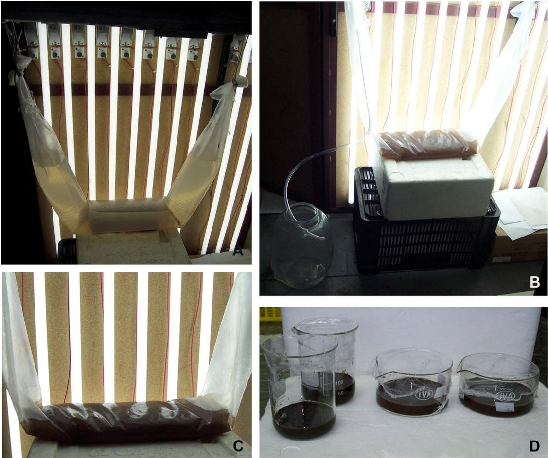
**Figura 1.** Proceso de cosecha de *Haematococcus pluvialis*. **A:** concentración de células por sedimentación. **B:** eliminación del medio de cultivo remanente. **C:** resultado de la sedimentación pasiva. **D:** biomasa centrifugada.
