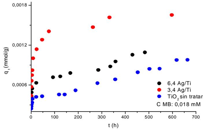
**Figura 1:** Cinética de adsorción de MB a una  $C_0$ : 0,018 mM en los materiales sintetizados. T: 25 °C
