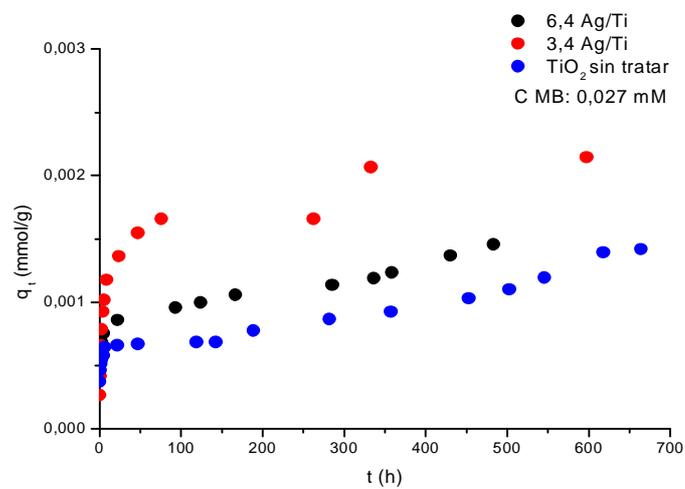
**Figura 3:** Cinética de adsorción de MB a una  $C_0$ : 0,027 mM en los materiales sintetizados. T: 25 °C
