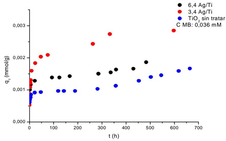
**Figura 4:** Cinética de adsorción de MB a una  $C_o$ : 0,036 mM en los materiales sintetizados. T: 25 °C
