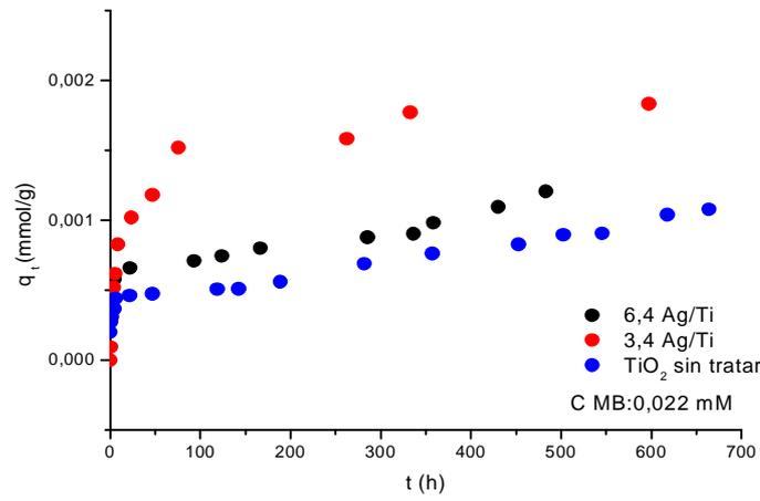
**Figura 2:** Cinética de adsorción de MB a una  $C_0$ : 0,022 mM en los materiales sintetizados. T: 25 °C
