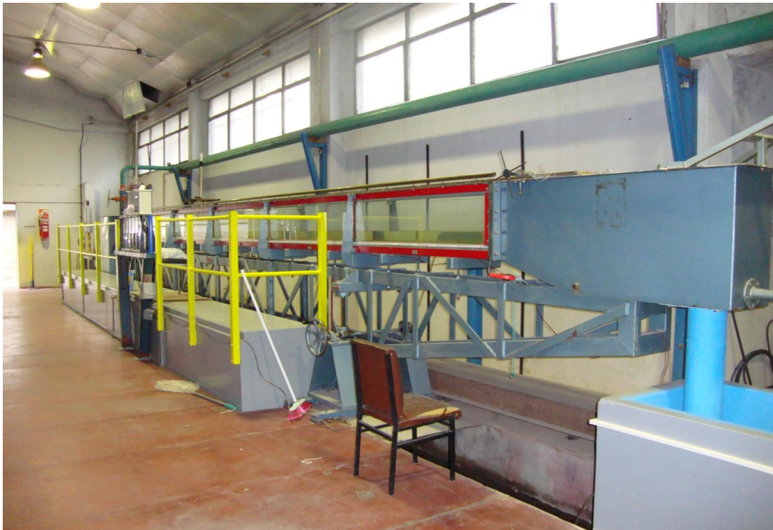
Figura 3.1. Canal experimental vidriado ubicado en el Laboratorio de Hidráulica (Departamento de Ingeniería, Universidad Nacional del Sur).
