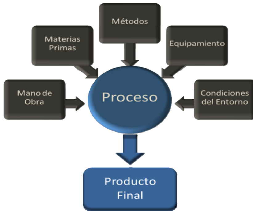
Figura 2.1: Esquema de la relación entre la calidad final del producto y las posibles fuentes de variación
